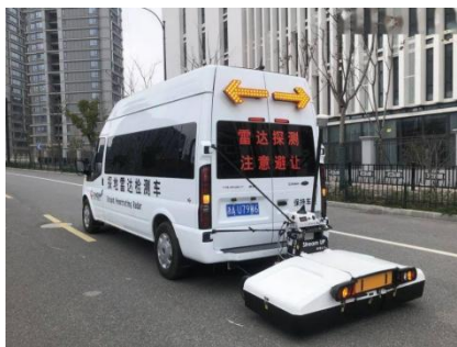
图 1：探地雷达设施应用场景示意图
