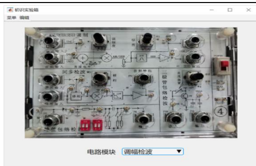
图2 初识试验箱之调幅检波电路
