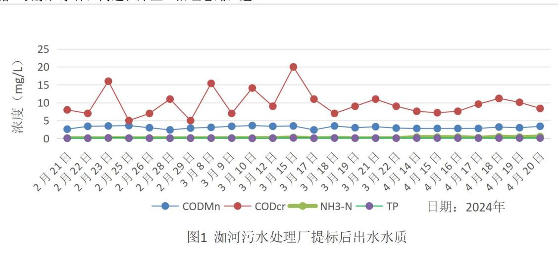
图1 榆河污水处理厂提标后出水水质
