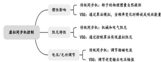
图 2：虚拟同步机控制模拟工作原理特性
