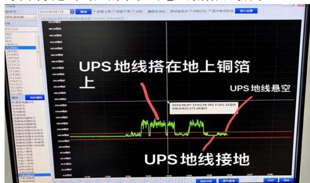
图 4 UPS 地线不同状态时对应的小轨出电压采集曲线
