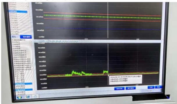
图 5 小轨出电压波动恢复正常
