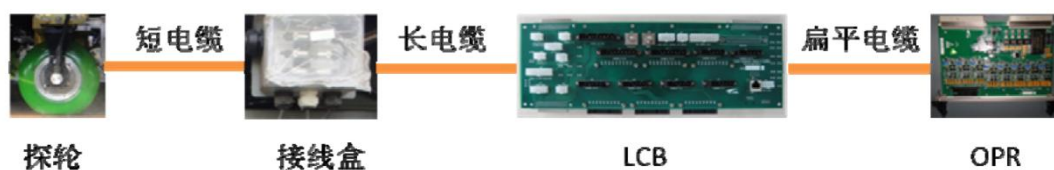
图 2 超声信号在电缆中传播途径示意图
