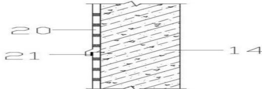
图2 地下室外墙卷材铺设后的结构示意图
