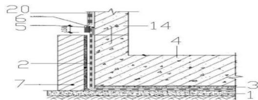
图1 地下室底板卷材铺设后的结构示意图
