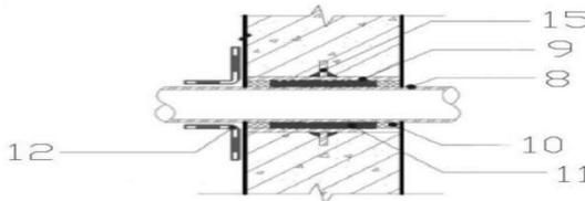
图3 穿墙管与混凝土侧墙之间的连接结构示意图
