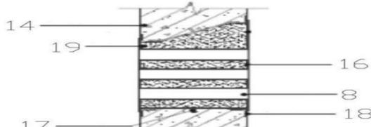
图4 穿墙管群与混凝土侧墙之间连接结构示意图
